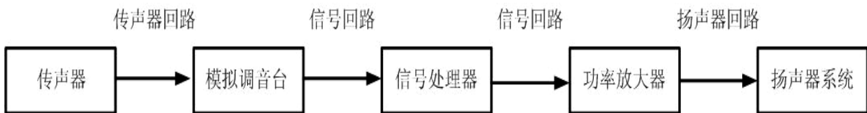
图1 剧场等演出场所扩声系统音频信号流程图
